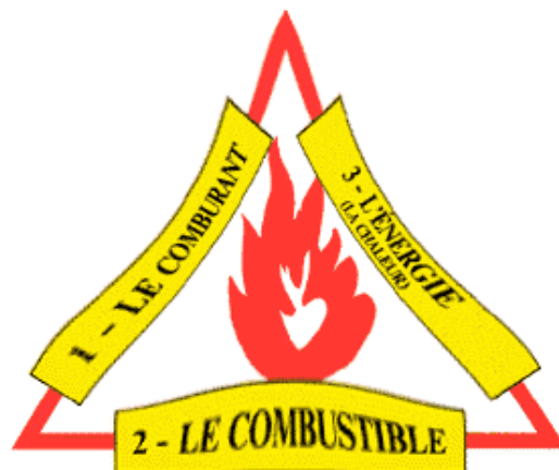
Figure 6 : Éléments nécessaires pour le déclenchement d'un incendie
