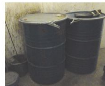
Stockage des déchets de perchloroéthylène dans des fûts spécifiques
